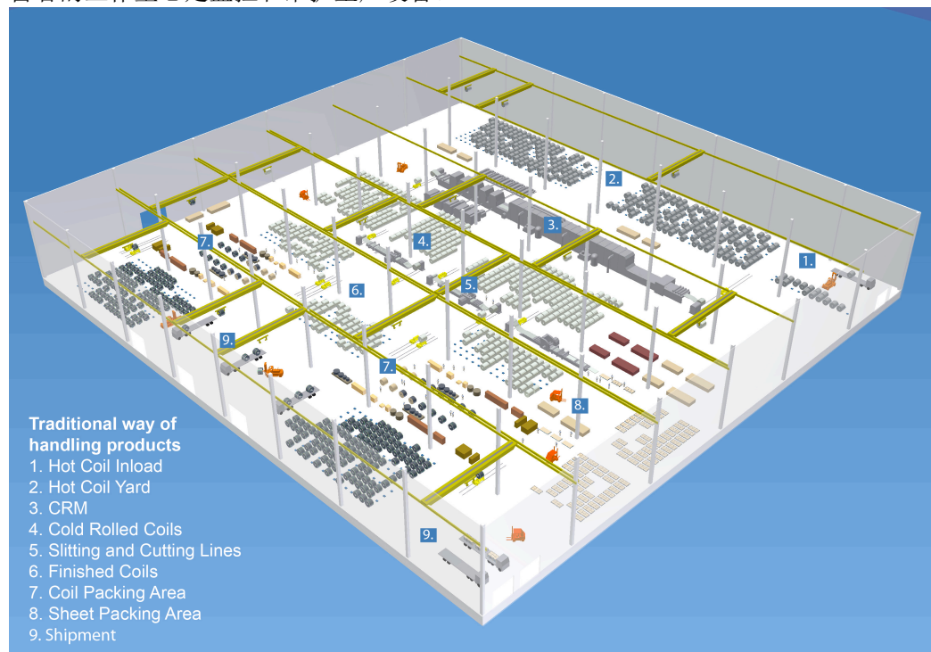
图 1：传统的冷轧工厂布局图。原料、半成品和成品的运输、储存、分类、包装和发运由操作工人完成。
