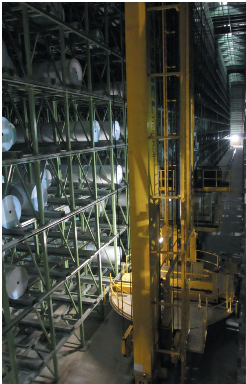
图2 亚太新会文化纸厂的TransRoll堆垛机正在对纸卷进行分类存放
