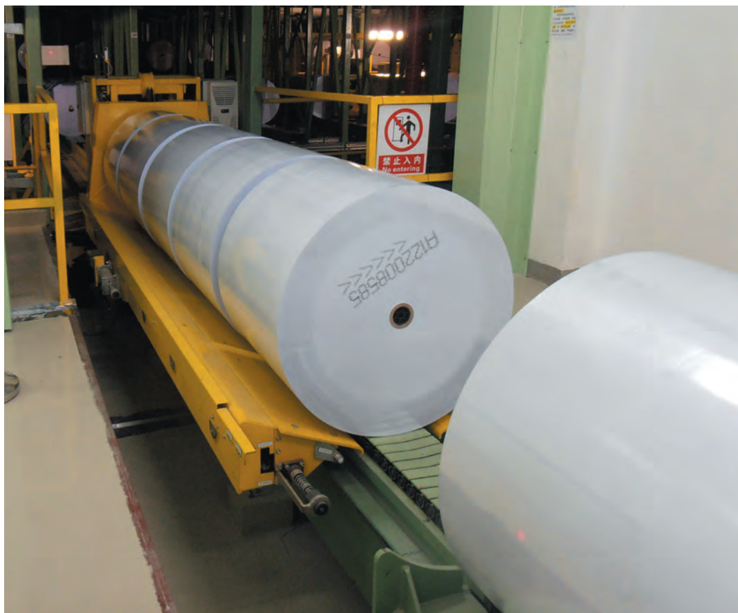
图4 在中间库入口处TransRoll分类小车对多个纸卷进行分类
