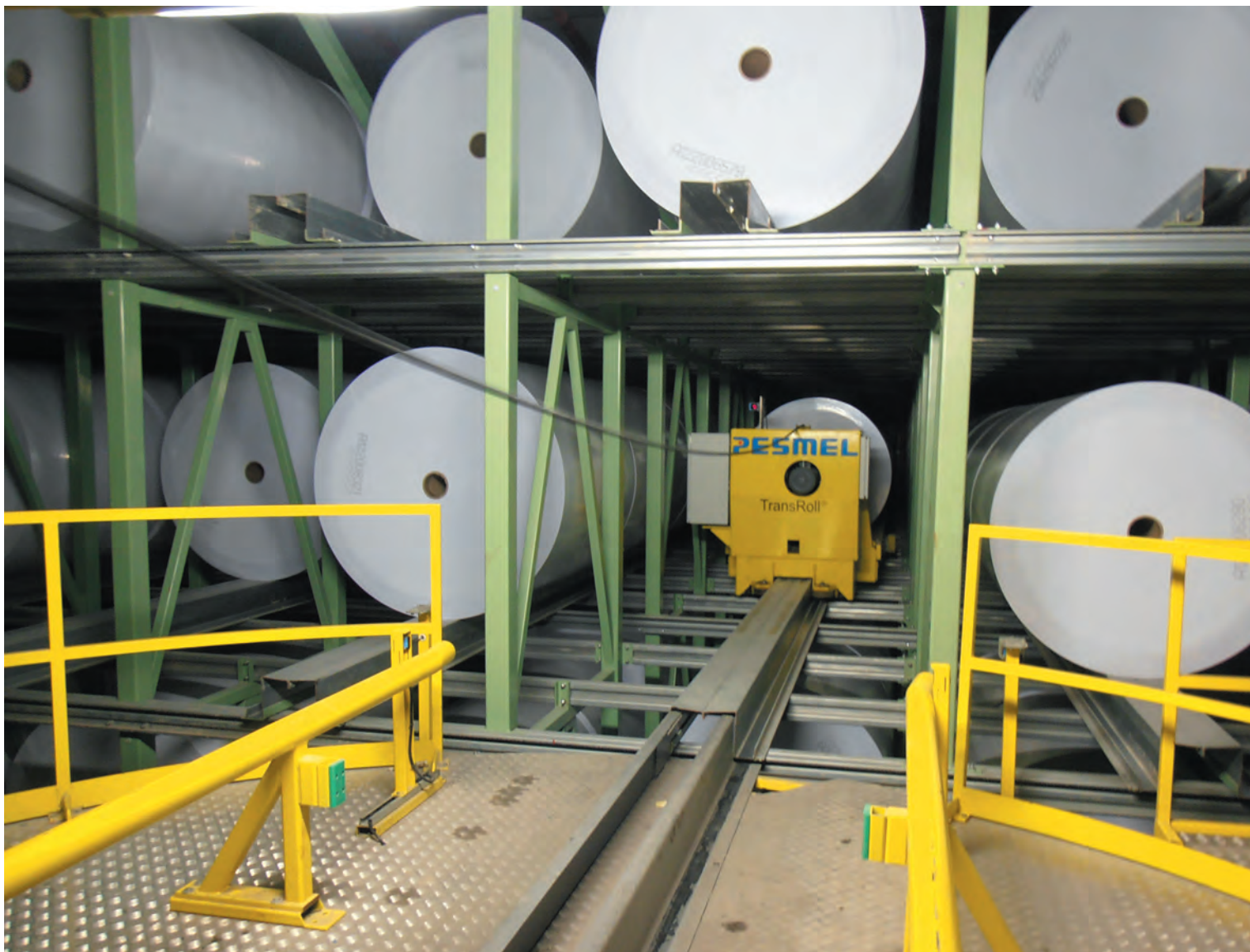
图6 TransRoll分类小车根据仓库订单将纸卷输送到包装或者发货口
